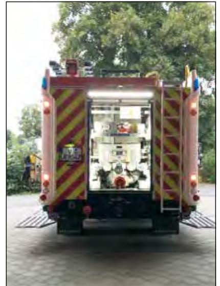
Das Fahrzeug ist einschließlich des Fahrers für eine Besatzung von neun Kräften ausgelegt und besitzt einen Motor von 290 PS. Auch in bergigen Regionen zeigt es dank Allradantrieb ein gutes Fahrhalten, ist jedoch auf eine Geschwindigkeit von unter 100 Stundenkilometern ausgelegt. Wie andere Kraftfahrzeuge unterliegt es den TÜV-Bestimmungen und muss darüber hinaus zu Sonderuntersuchungen vorgestellt werden.
